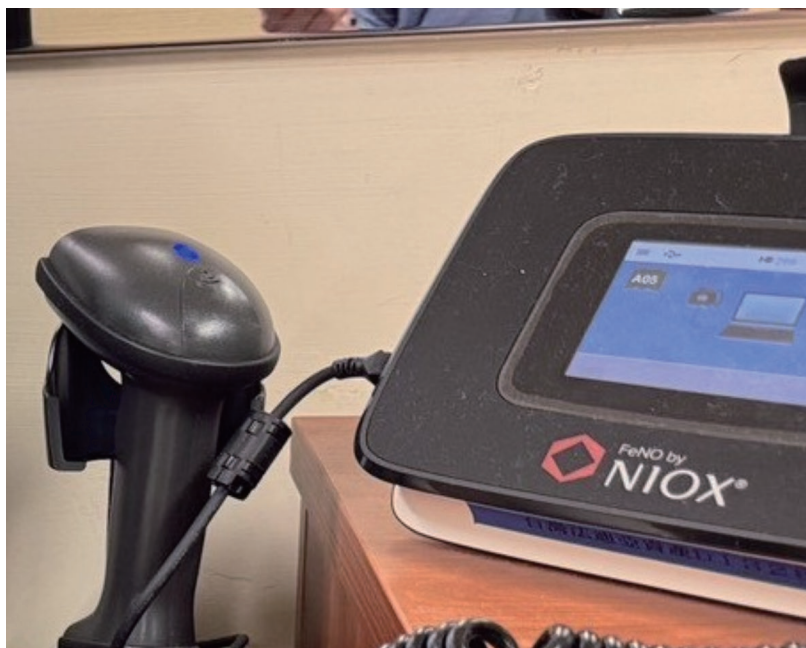
圖 9-1、NIOX VERO® 電化學 FeNO 分析儀（高雄長庚胸腔內科檢查室實景）。機體含彩色觸控螢幕、條碼掃描器與底部呼吸手柄基座；機身正面之「FeNO by NIOX®」識別標誌可確認儀器型號。
