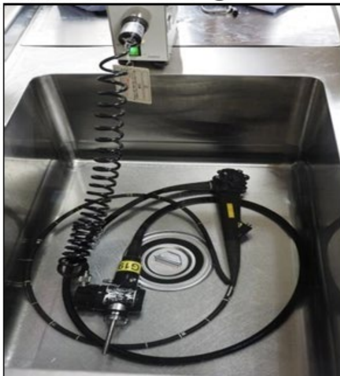
圖 3A. 機械濕式測漏
