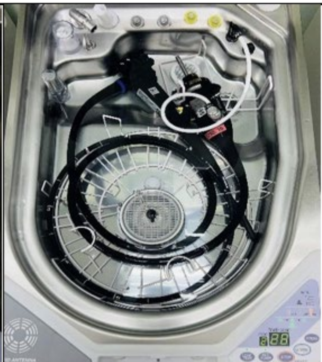
圖 3C. 自動化內視鏡再 處理機測漏
